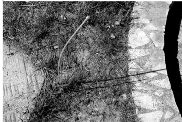
Figure 12. Pour expérimenter cette mesure du temps et de l'espace, des aiguilles à tricoter jouent le même rôle. On les plante dans le sol en tournant la partie dorsale de celle qui est arrondie vers le nord. Un fil à plomb permet de bien placer celle qui est droite. Cet outil est absolument efficace pour savoir quotidiennement le moment du midi local ou bien le minuit local avec la culmination de la lune.
